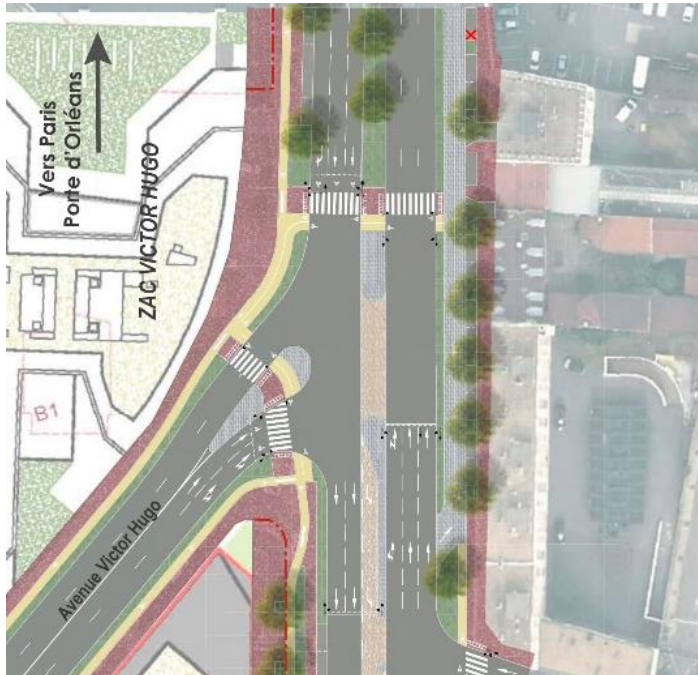
Figure 9 : carrefour à l'angle de l'avenue Victor Hugo à Bagneux - gestion des mouvements tournants significatifs favorisant le bon fonctionnement de la RD 920
